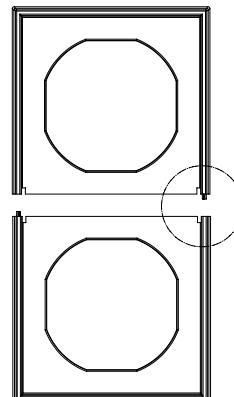
De twee dichtingsringen zijn eenvoudig aan elkaar te koppelen.
