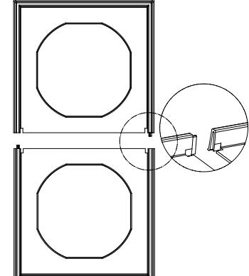
Les deux bagues d'étanchéité peuvent être facilement connectées l'une à l'autre.
