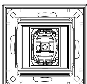
De dichtingsring beschermt tegen het binnendringen van water in de inbouwdoos, tegelijkertijd dient deze ook als uitvulling voor stucwerk.
