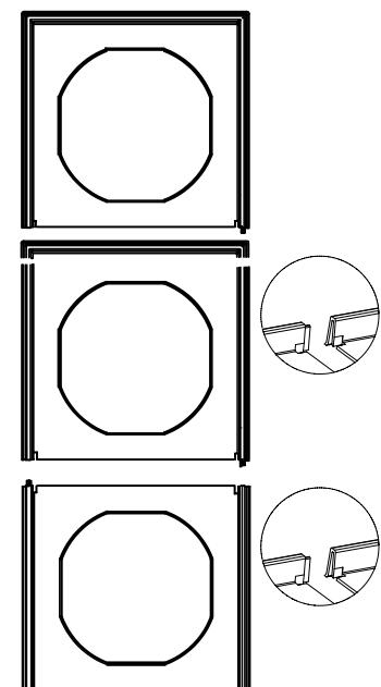
Avec une plaque de recouvrement triple, la bague d'étanchéité au milieu, coupé le bord extérieur au-dessus sur le marquage (avec une plaque de recouvrement quadruple au deuxième milieu). Ensuite ils peuvent être facilement reliés entre eux.
