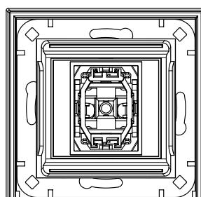
La bague d'étanchéité protège contre la pénétration de l'eau dans la boîte encastrée, dans le même temps il sert également de supplément pour le stuc.
