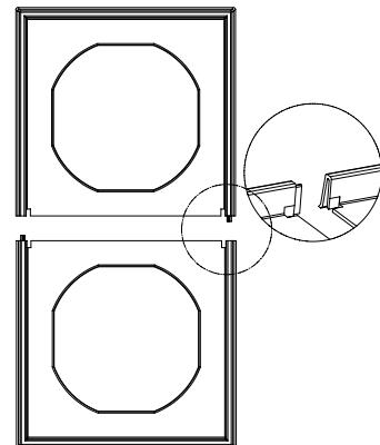
Die beiden Dichtungs-Topringe werden einfach zusammengesteckt.
