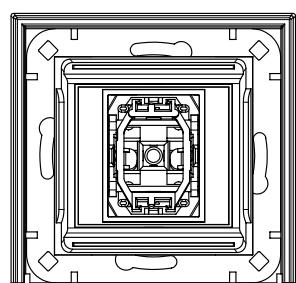
Der Dichtungs-Topring dient auch als Putzausgleich für Einzeldosen Ø 55 mm, er schützt vor Eindringen des Spritzwassers in die Schalterdose.
