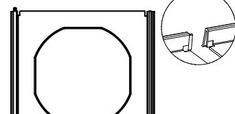
In diesen Fällen wird am mittleren bzw. den 2 mittleren Dichtungs-Topringen die obere Außenkante an der Markierung abgeschnitten und einfach zusammengesteckt.
