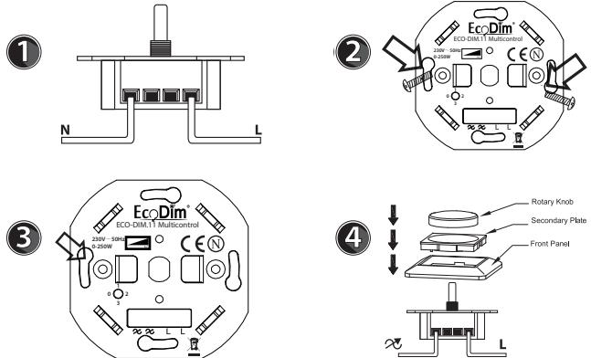
**Stap 1:** Zorg er altijd voor dat de elektriciteit tijdens de installatie is uitgeschakeld. Sluit vervolgens de stroomdraden aan zoals aangegeven in het 'Aansluitschema'.
