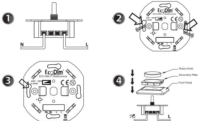
**Schritt 1:** Stellen Sie immer sicher, dass der Strom während der Installation ausgeschaltet ist. Schließen Sie dann die Stromkabel wie im "Anschlussplan" angegeben an.
